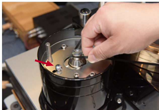
△ AF III Premium採用沒有任何彈性的聚氨酯纖維 (polyurethane fiber) 扁帶作帶動，由於這條扁帶不像其他傳統膠帶般有一定的彈性(有彈性亦等如會因為使用日久而拉長和老化)，所以需要調節連接馬達本體的一枚螺絲來取得適當的拉力。
