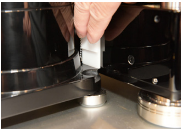
△ 這一塊白色的墊片是用來準確調校分體馬達和唱盤基座的分隔距離。
