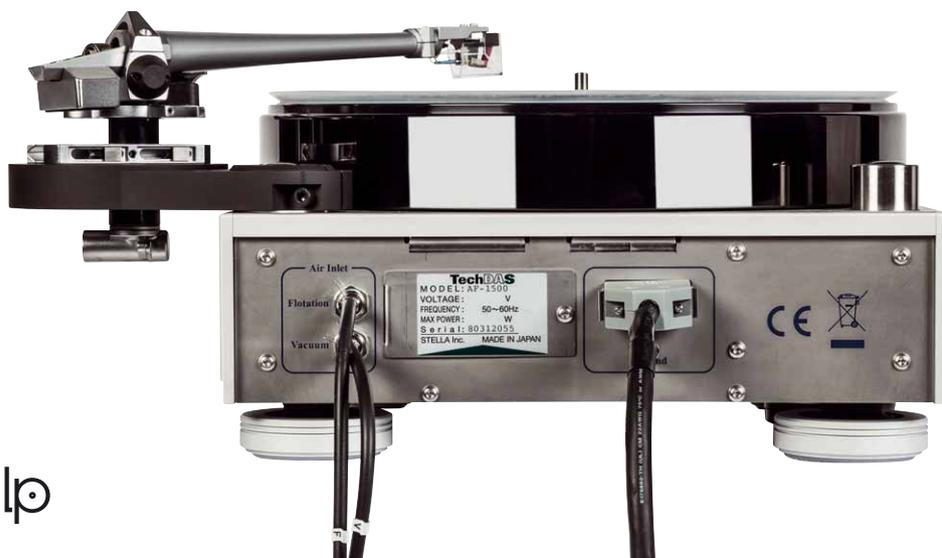
Das Gerät darf auch hinter dem Rack verschwinden, weil man's eh nur ein einziges Mal einschalten und dann nie wieder bedienen muss. Der doppelte Luftschlauch ist lang genug, das Steuerkabel zwischen Dreher und Lufteinheit auch. Auch hier gibt's ein Über- und ein Unterdrucksystem; eine Pumpe besorgt den Überdruck fürs Tellerlager, eine zweite den Unterdruck für die Ansaugung, deshalb die zwei Luftschläuche.
