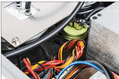
Hier erkennt man Filter zur Feuchtigkeitsabscheidung in der Luftaufbereitung
